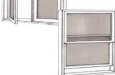
**Fenêtre à guillotine** : fenêtre caractérisée par deux châssis dont au moins un est conçu pour coulisser verticalement
